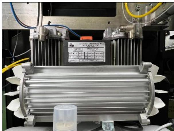
✓ Démontage des cylindres et remplacement du segment de piston (commencer par un côté, puis passer à l'autre)
