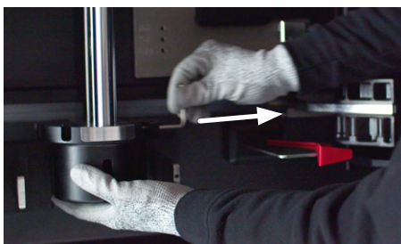
8. Retirar el pasador que sujeta el empujador.
