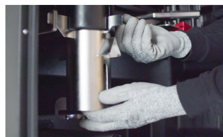
6. Desenroscar la tuerca del soporte.
