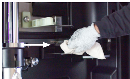
1. Limpiar las cuchillas fijas.
